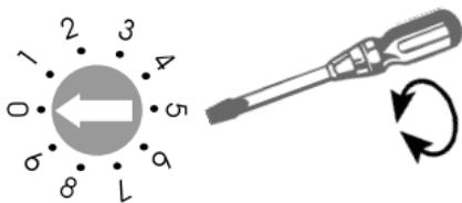
Alleen wanneer er in een huis systemen van verschillende gebruikers werkzaam zijn, moeten de apparaten van de afzonderlijke gebruikers op verschillende kanalen ingesteld worden.
