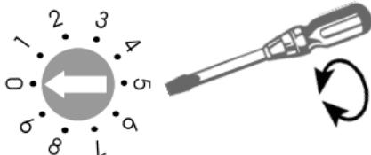
Se in un edificio sono fatti funzionare gli impianti di diversi utenti, gli apparecchi dei singoli utenti devono essere impostati su canali radio diversi. Servirsi di un piccolo cacciavite per impostare il numero del canale desiderato.
