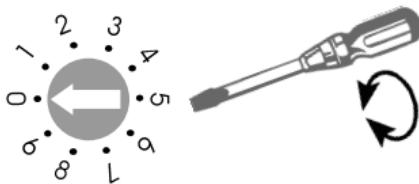
Ce n'est que dans le cas où l'on utiliserait simultanément dans un même bâtiment différentes installations, qu'il faudrait régler les appareils des différents utilisateurs sur des canaux différents.
