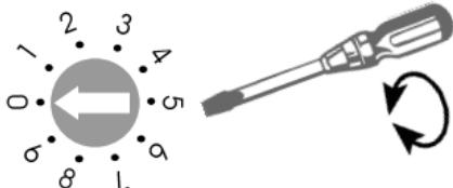
Nur wenn in einem Haus Anlagen von verschiedenen Benutzern betrieben werden, müssen die Geräte der einzelnen Benutzer auf unterschiedliche Funk-Kanäle eingestellt werden.
